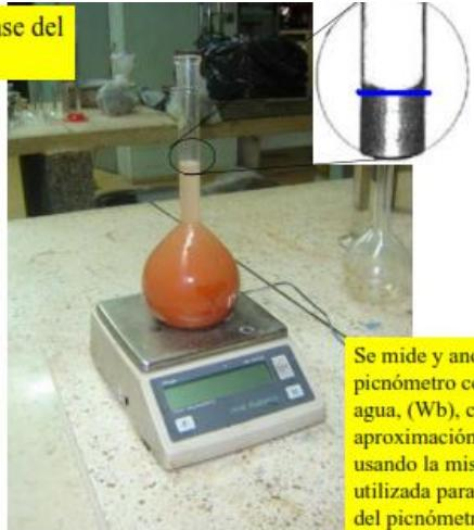
Se mide y anota la masa del picnómetro con suelo y agua, ( $W_b$ ), con una aproximación de 0.01g, usando la misma balanza utilizada para la calibración del picnómetro.
