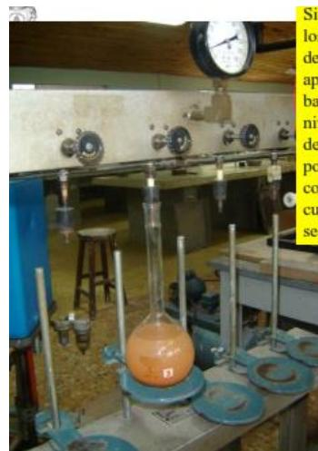
Si se usa una combinación de calor y vacío los picnómetros se pueden colocar en un baño de agua tibia (a no más de 40°C) durante la aplicación del vacío. El nivel de agua en el baño debe estar ligeramente por debajo del nivel de agua en el picnómetro. La duración de la combinación de vacío y calor debe ser por lo menos de una hora, después de que comienza el hervor. La lechada debe agitarse cuando sea necesario para evitar que el suelo se seque y se pegue al picnómetro.
